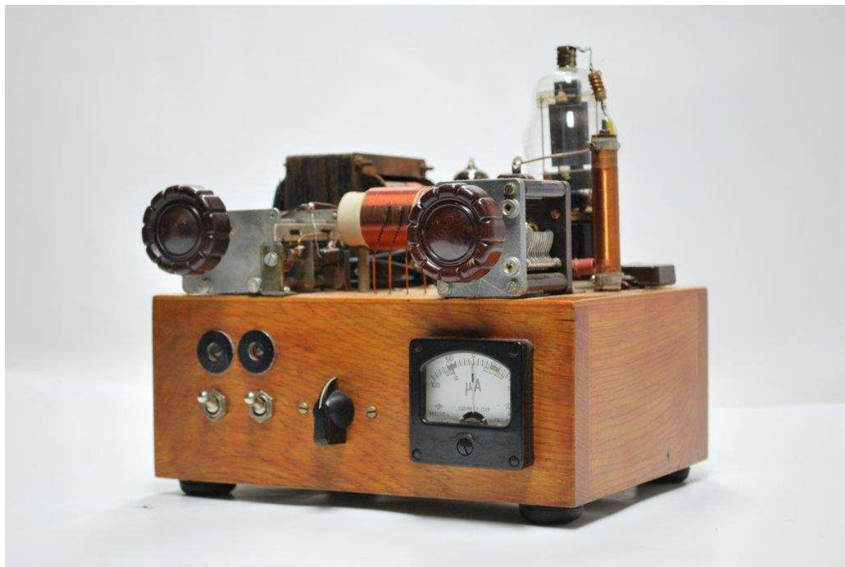
Wzmacniacz lampowy QRP 20W – nieznanego autorstwa otrzymany od Janka SP7KI
